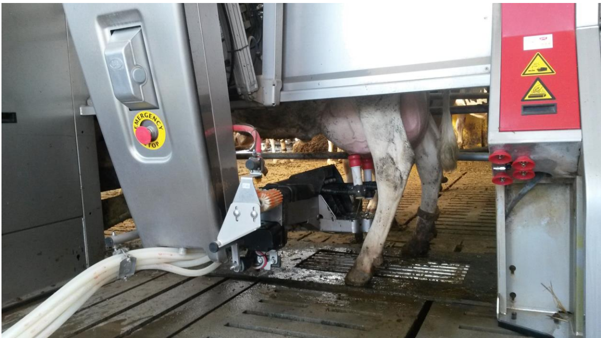
Abb. 2: Melkroboter mit automatischer Euterreinigung
